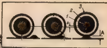
Depăsirea osiei (a) este cu mult mai mică decît depășirea geantii (A) roții de motocicletă. 1 — osie; 2 — bușca de cauciuc; 3 — geanta (sus).
